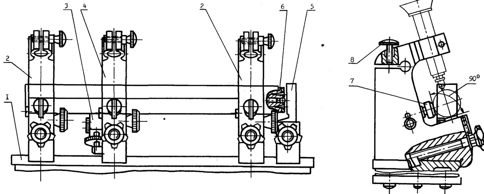
Рис. 3.31. Приспособление для контроля отклонений от круглости и профиля продольного сечения валов:
