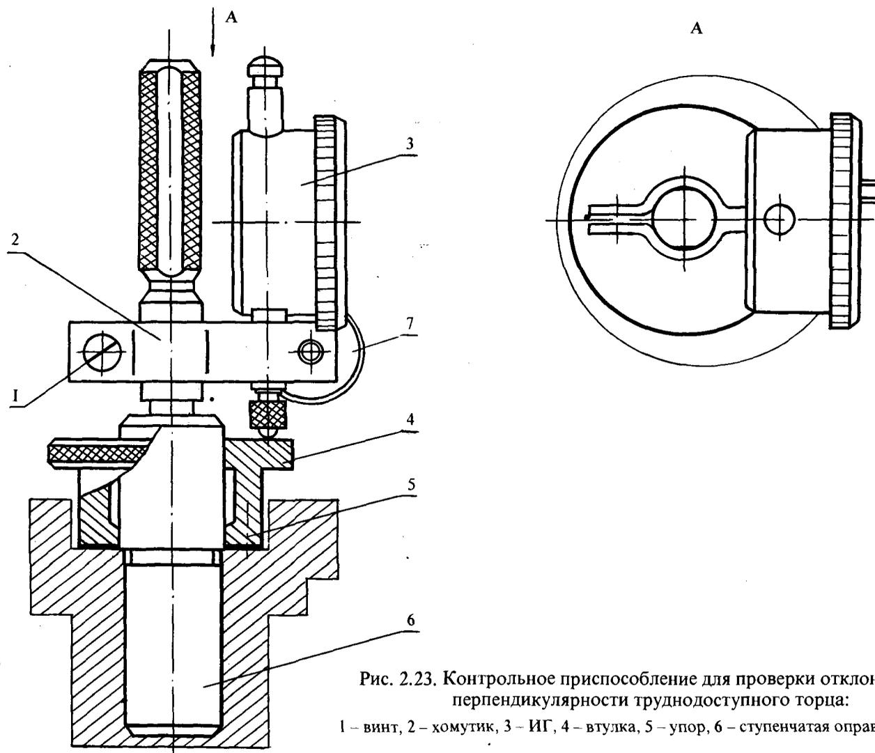
Рис. 2.23. Контрольное приспособление для проверки отклонения от перпендикулярности труднодоступного торца:
