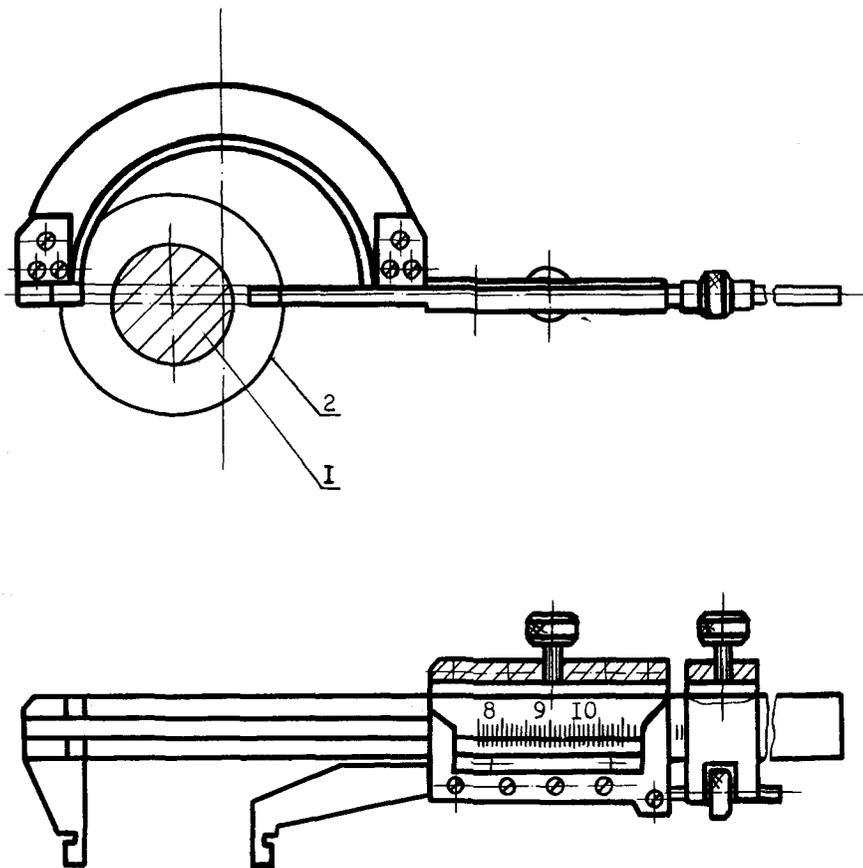
Рис. 2.27. Штангенциркуль со специальной скобой:
