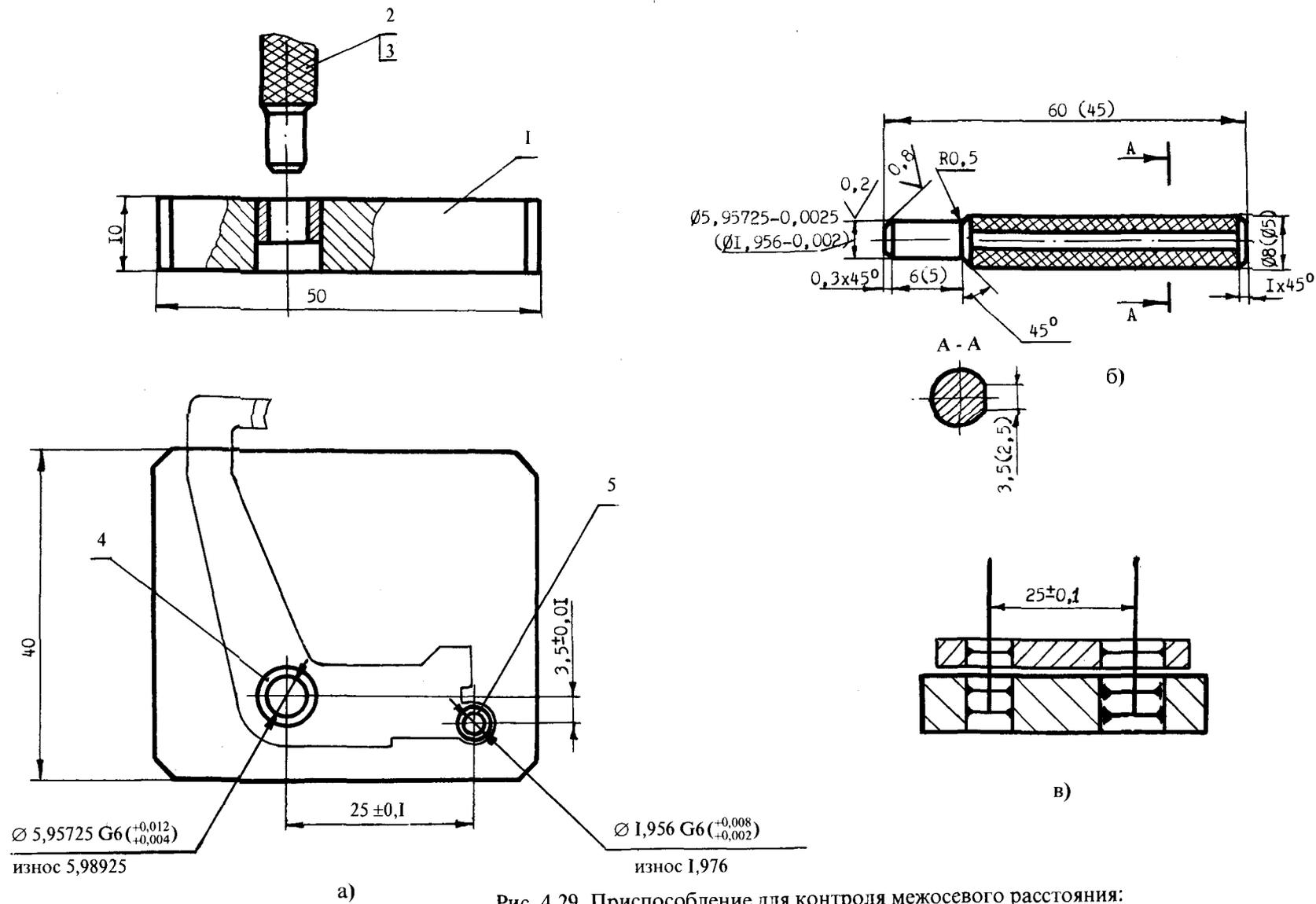
Рис. 4.29. Приспособление для контроля межосевого расстояния:
