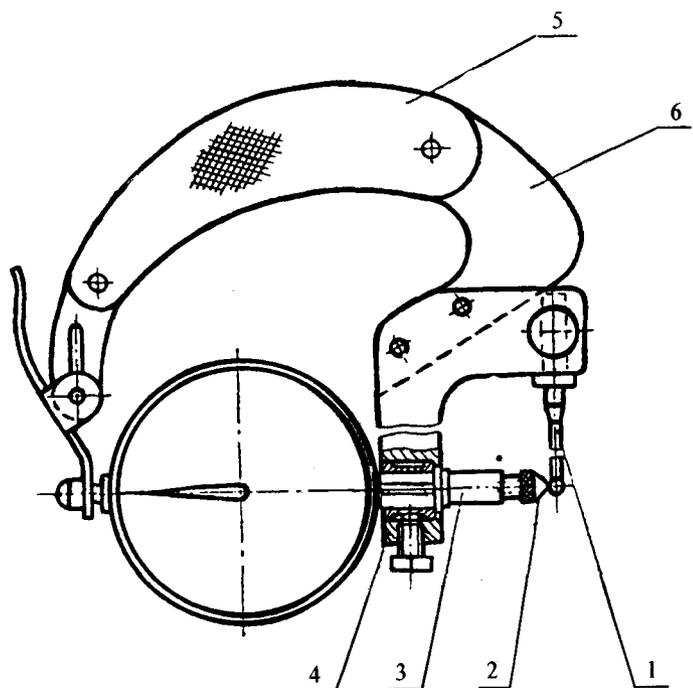
Рис. 3.19. Приспособление для измерения толщин стенок распорных трубок:
