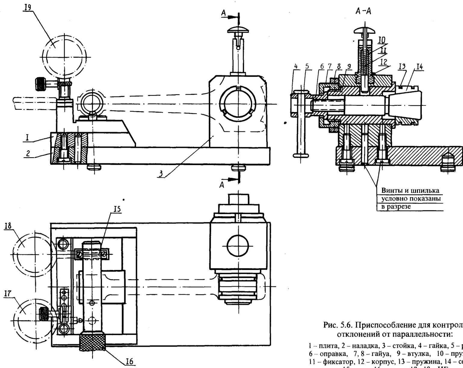
Рис. 5.6. Приспособление для контроля отклонений от параллельности:
