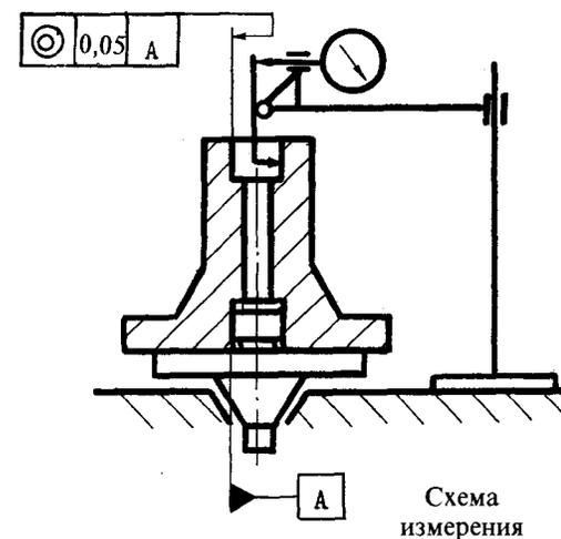
Рис. 2.7. Контрольное приспособление для проверки радиального биения выточки:
