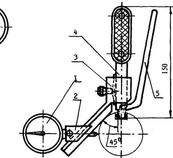
Рис. 3.27. Приспособление для контроля смещения шпоночного паза:
