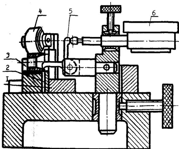
Рис. 2.34. Приспособление для контроля угла в дисках с конусным отверстием:
