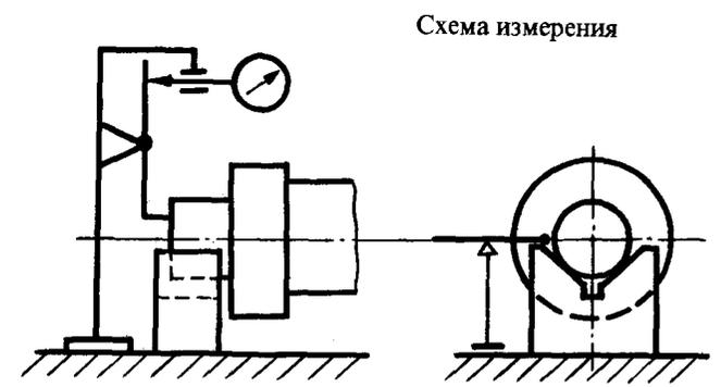
Рис. 3.8. Приспособление для контроля торцового биения:
