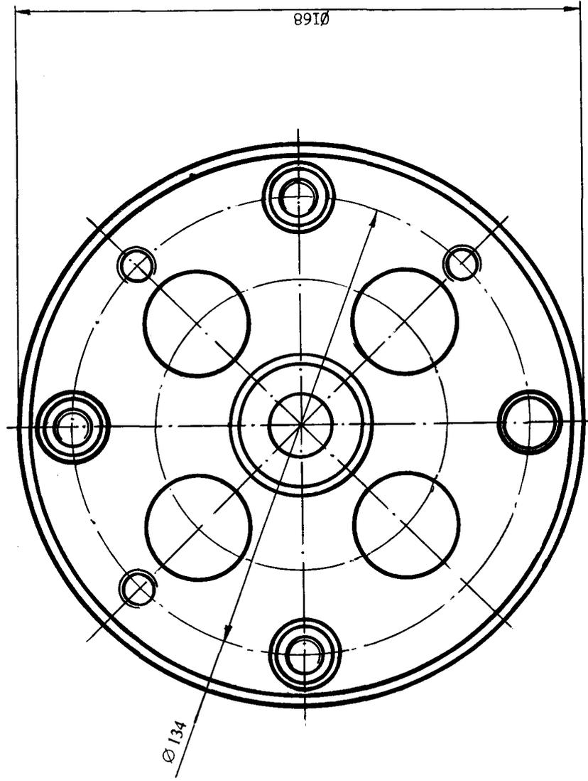
Рис. 2.25. Приспособление для контроля расположения отверстий:
