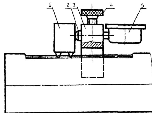
Рис. 3.33. Приспособление для контроля отклонений
