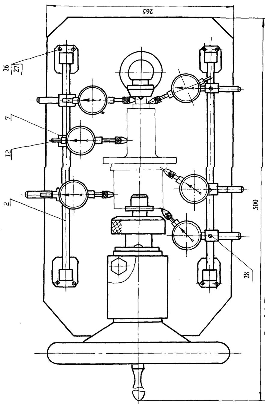
Рис. 3.6. Приспособление для контроля радиального и торцового биений:
