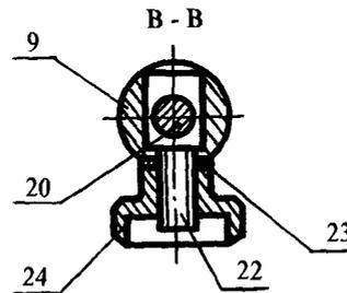
Рис. 3.11. Контрольное приспособление для проверки отклонений от параллельности шлицев валов:
