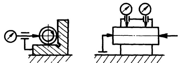
Рис. 3.9. Приспособление для проверки отклонения от цилиндричности гладких валов:
