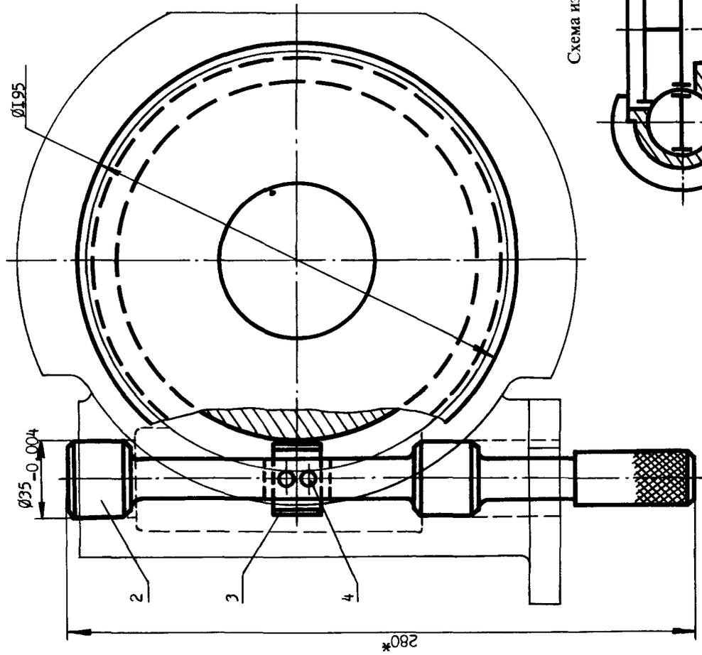
Рис. 4.5. Приспособление для контроля межцентрового расстояния:
