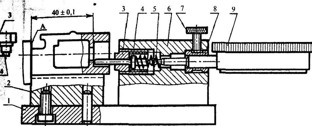
Рис. 4.26. Приспособление для контроля внутреннего линейного размера:
