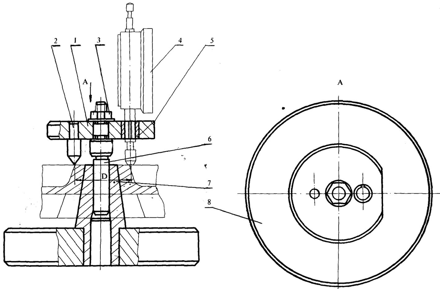
Рис. 2.17. Контрольное приспособление для проверки биения торцов у дисков с коническим отверстием:
