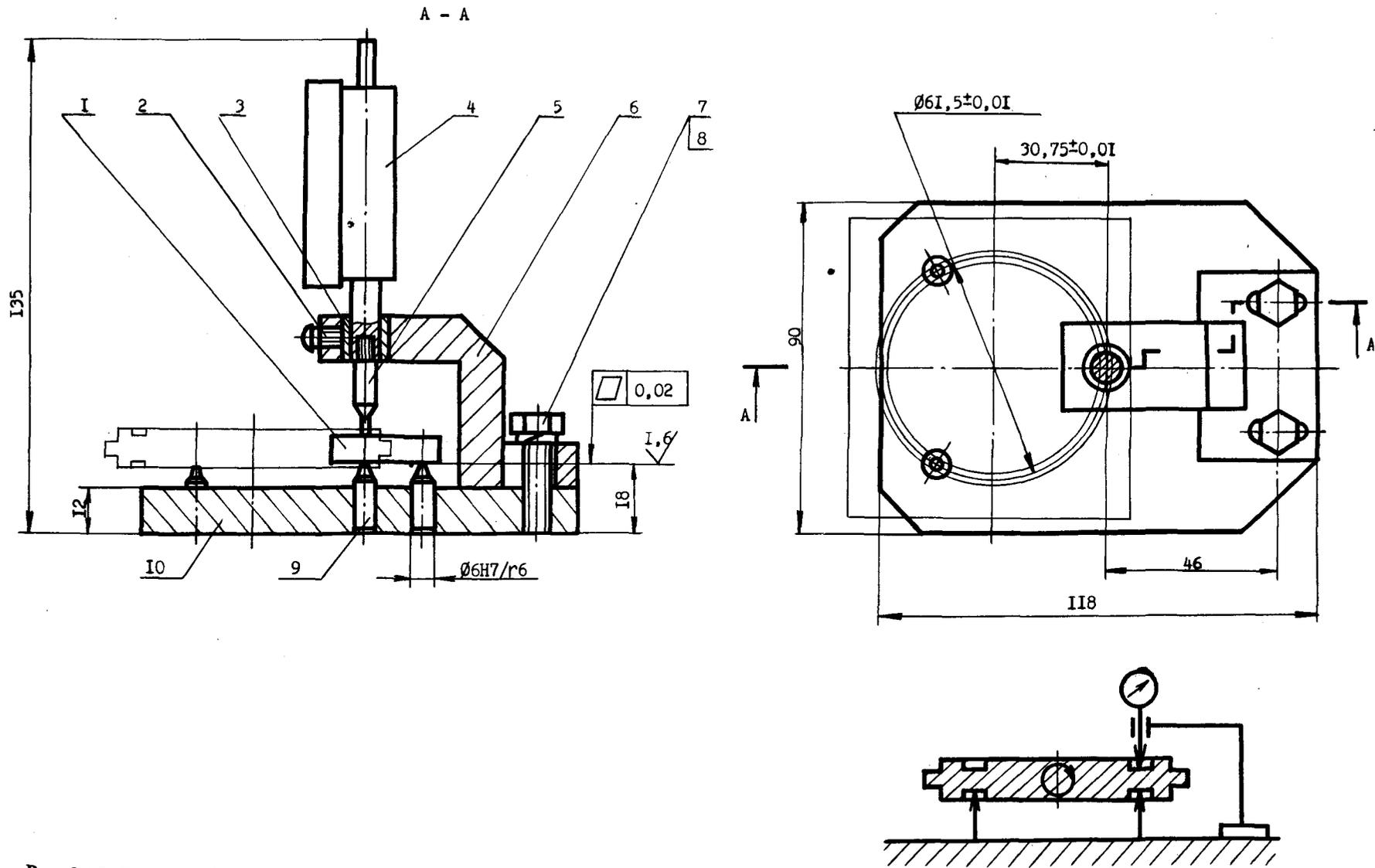
Рис. 2.15. Приспособление для контроля отклонения от параллельности плоскостей:
