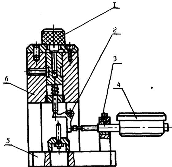
Рис. 3.25. Приспособление для контроля двух линейных размеров деталей типа валиков:
