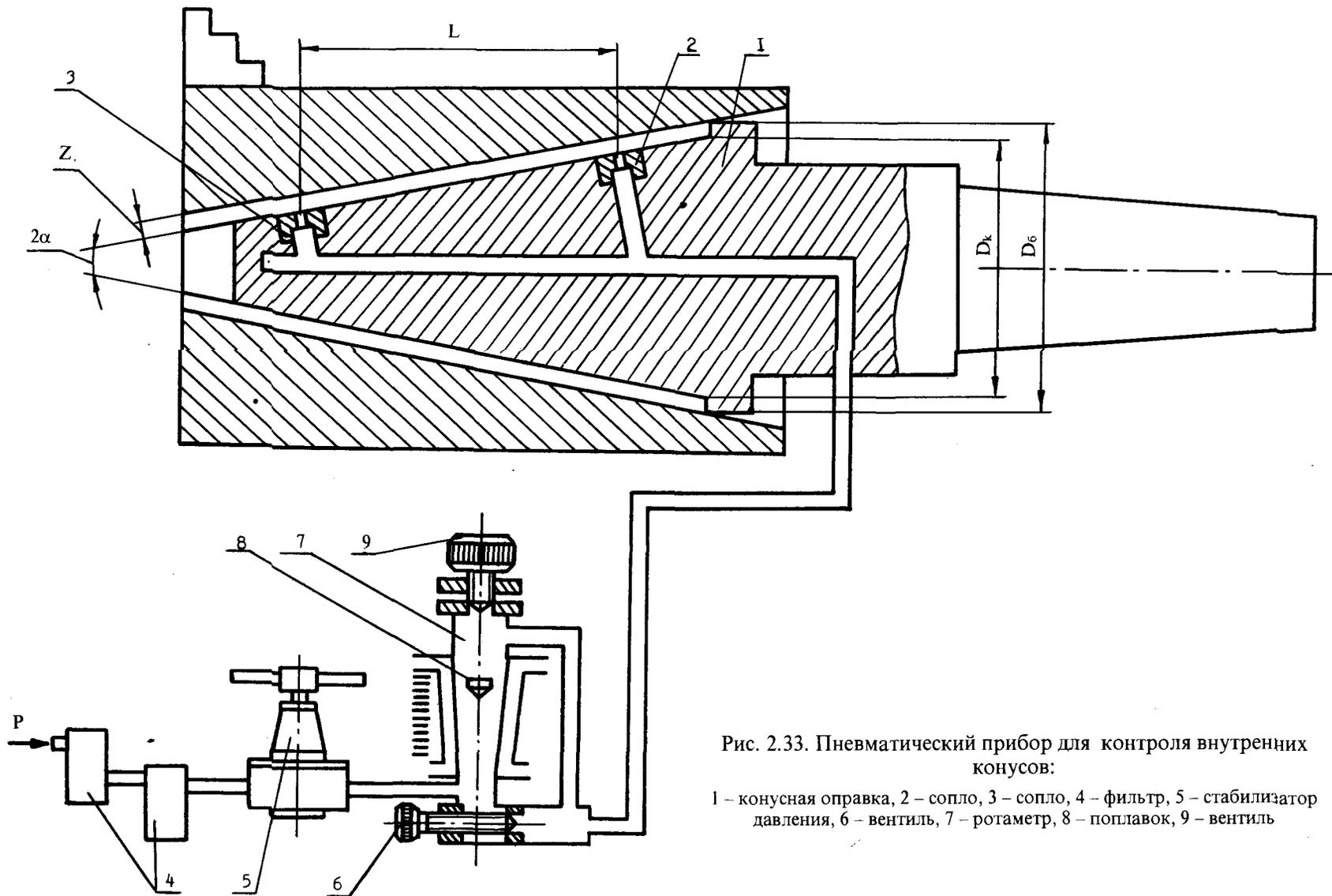
Рис. 2.33. Пневматический прибор для контроля внутренних конусов:
