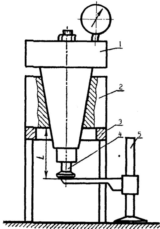
Рис. 5.7. Приспособление для контроля тарельчатых пружин:
