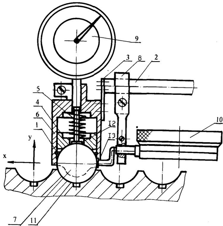
Рис. 5.1. Приспособление для контроля желобов фасонного профиля:
