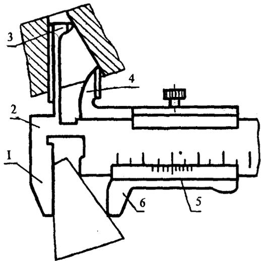
Рис. 2.29. Штангенциркуль для измерения конусов:
