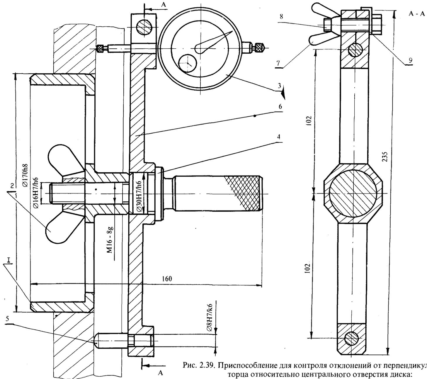
Рис. 2.39. Приспособление для контроля отклонений от перпендикулярности торца относительно центрального отверстия диска:
