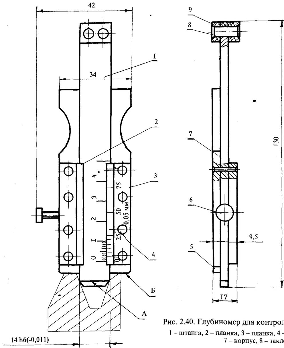
Рис. 2.40. Глубиномер для контроля расчетного диаметра шкива:
