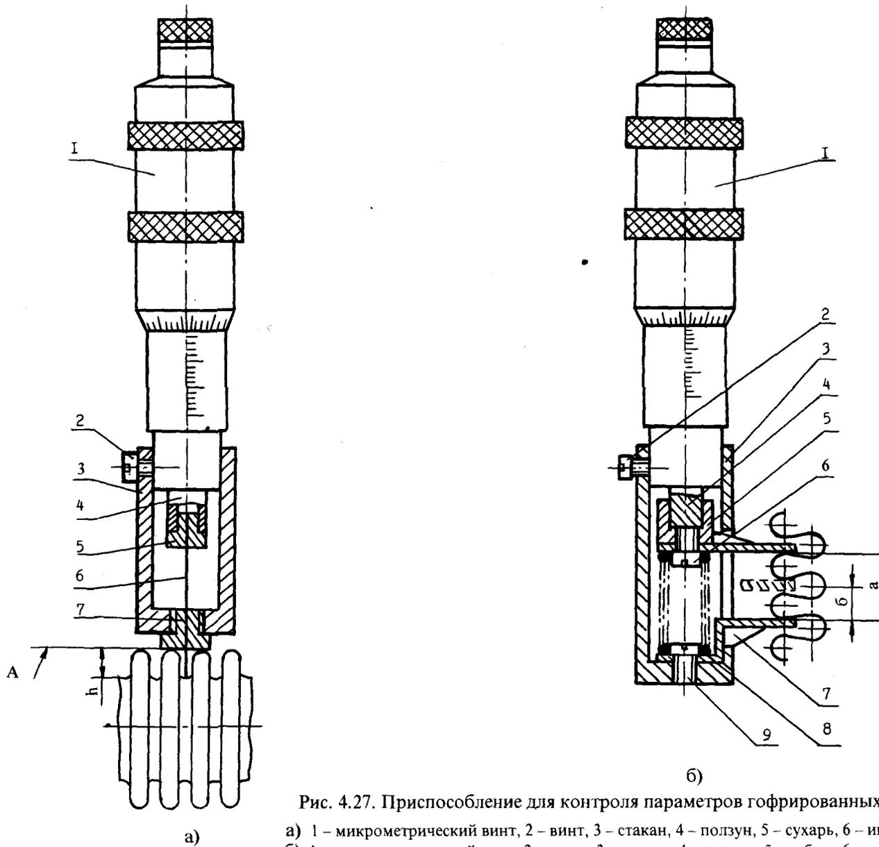
Рис. 4.27. Приспособление для контроля параметров гофрированных оболочек:
