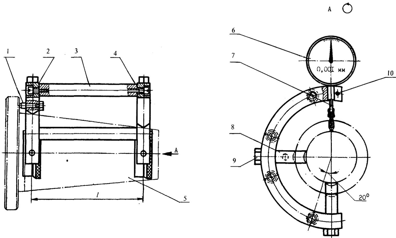
Рис. 3.45. Приспособление для контроля конусности:
