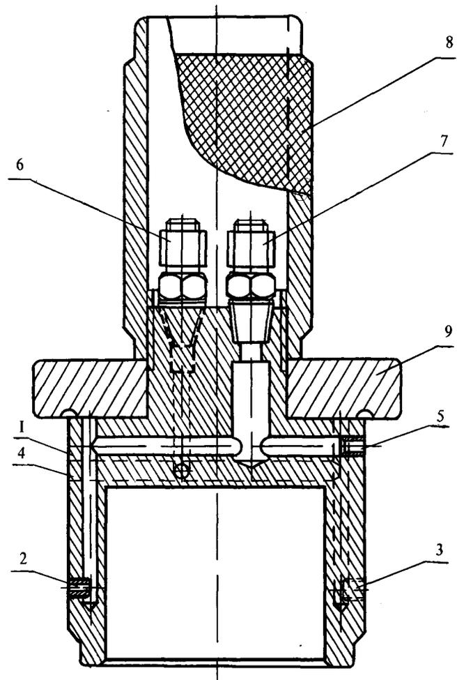
Рис. 4.24. Калибр - пробка пневматическая для проверки
