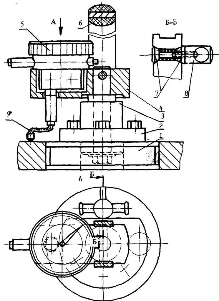
Рис. 3.2. Контрольное приспособление для проверки торцового биения:
