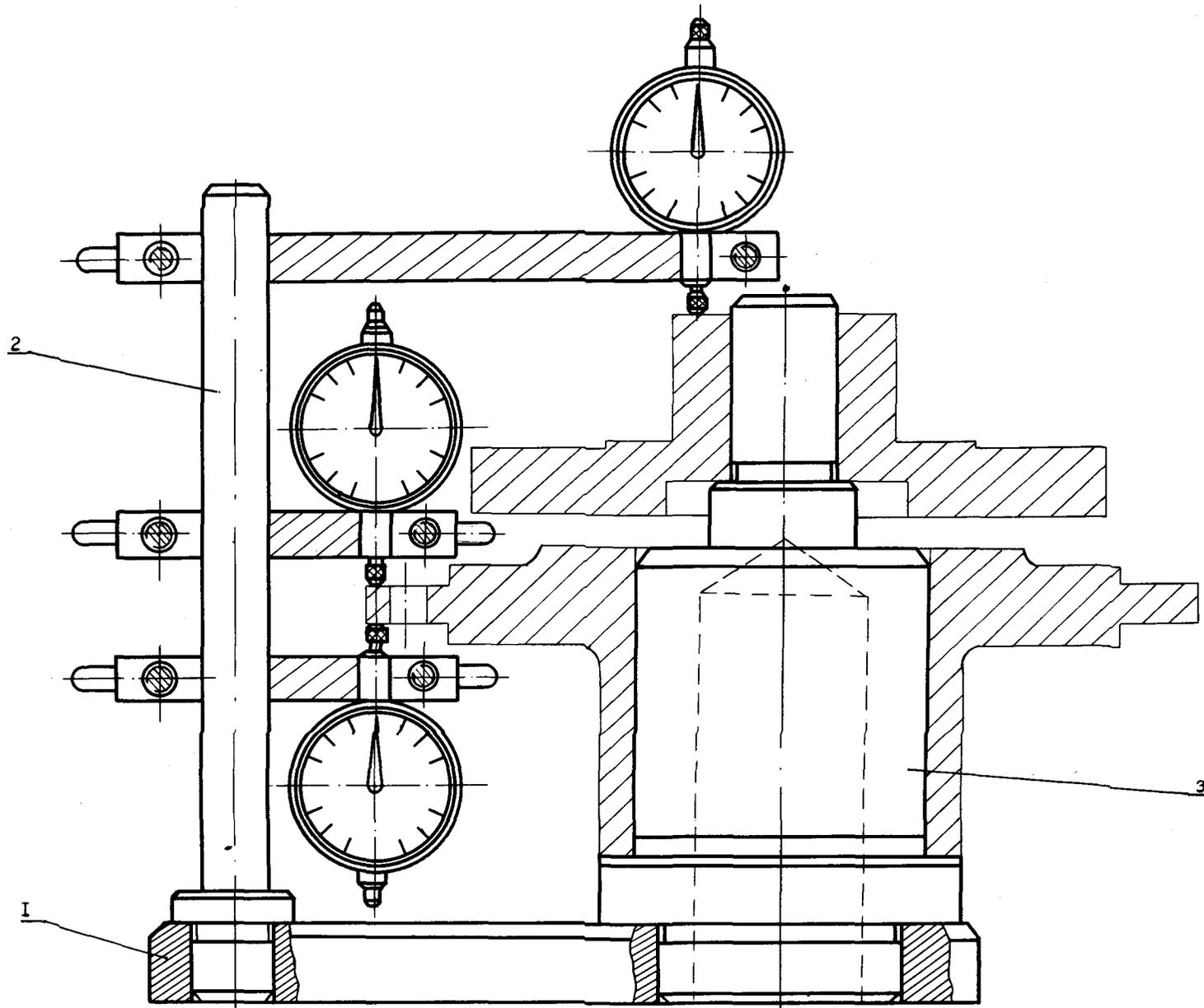
Рис. 2.10. Групповое контрольное приспособление для проверки торцового биения:
