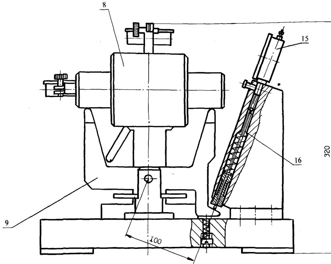
Рис. 4.20. Контрольное приспособление для проверки расположения осей отверстий у корпусов с базированием на кулачковую оправку (вид А на рис. 4.18):
