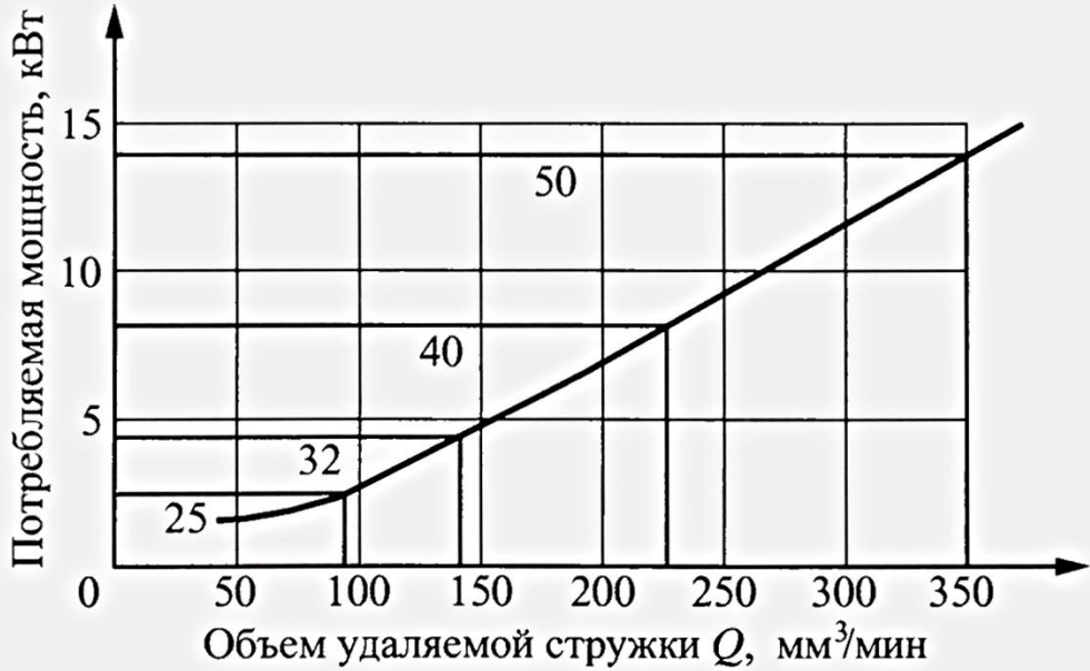
Рис. 9.1. Мощность, потребляемая для высокопроизводительного фрезерования стали (230 НВ): 25; 32; 40 и 50 – диаметр фрезы
