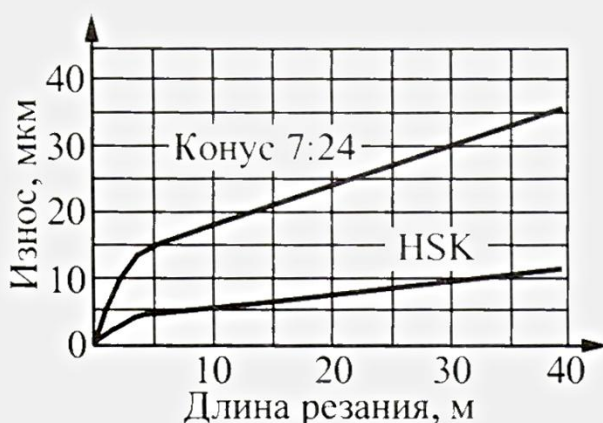
Рис. 8.7. Износ концевых твердосплавных фрез диаметром 16 мм
