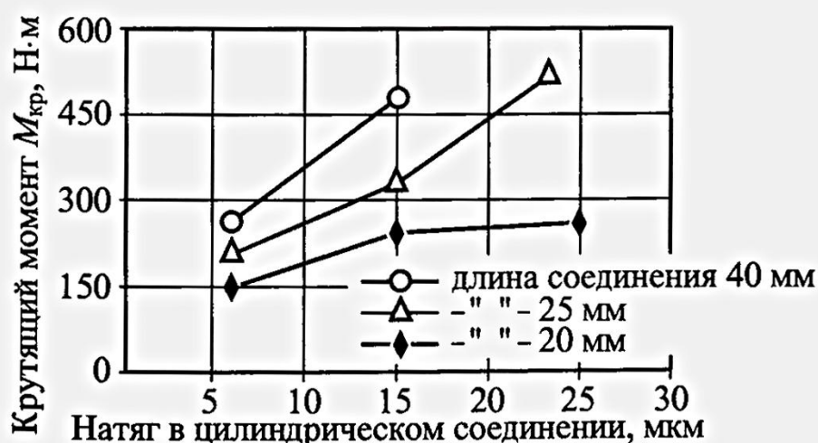
Рис. 8.26. Зависимость передаваемого крутящего момента от величины натяга в соединении патрон – инструмент диаметром 25 мм
