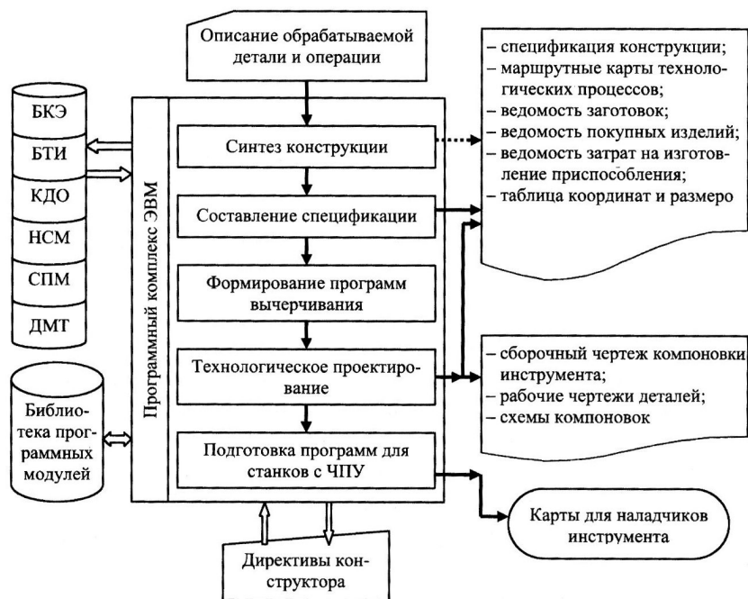
Р и с. 7.1. Укрупненная схема автоматизированного проектирования приспособлений для закрепления инструмента
