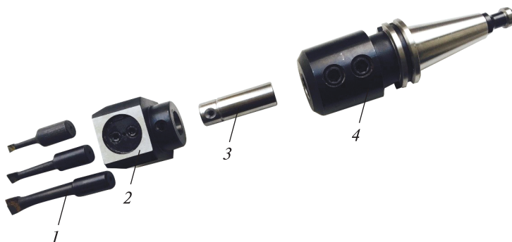
Рис. 13.1. Пример модульной инструментальной оснастки:
