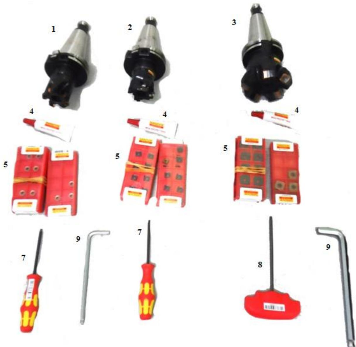
Рис. 8.3. Крепление торцевых фрез на оправках и сменных режущих пластин в корпусах фрез: 1 - оправка с торцевой фрезой с круглыми пластинами; 2 - оправка с торцевой фрезой для обработки уступов; 3 - оправка с торцевой фрезой с квадратными пластинами; 4 - тубы со смазкой; 5 - кассеты со сменными режущими пластинами; 7,8 - ключи для винтов, закрепляющих пластины; 9 - ключи для оправок.
