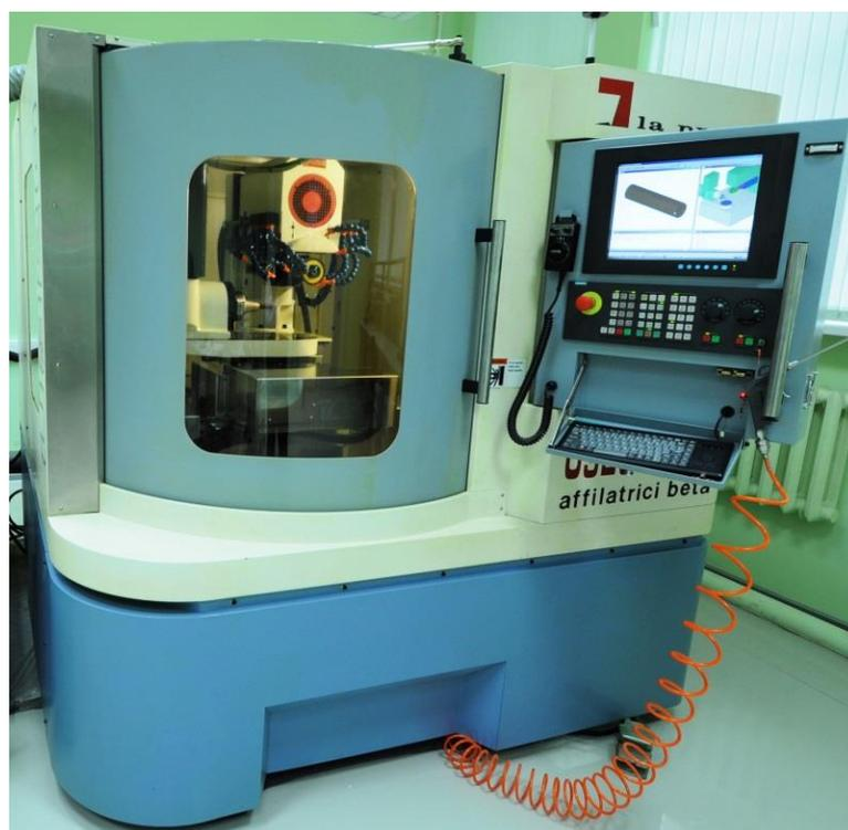
Рис. 9.2. Универсальный 5-координатный шлифовально-заточной центр
