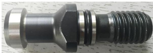
Рис. 8.6. Захватный болт
