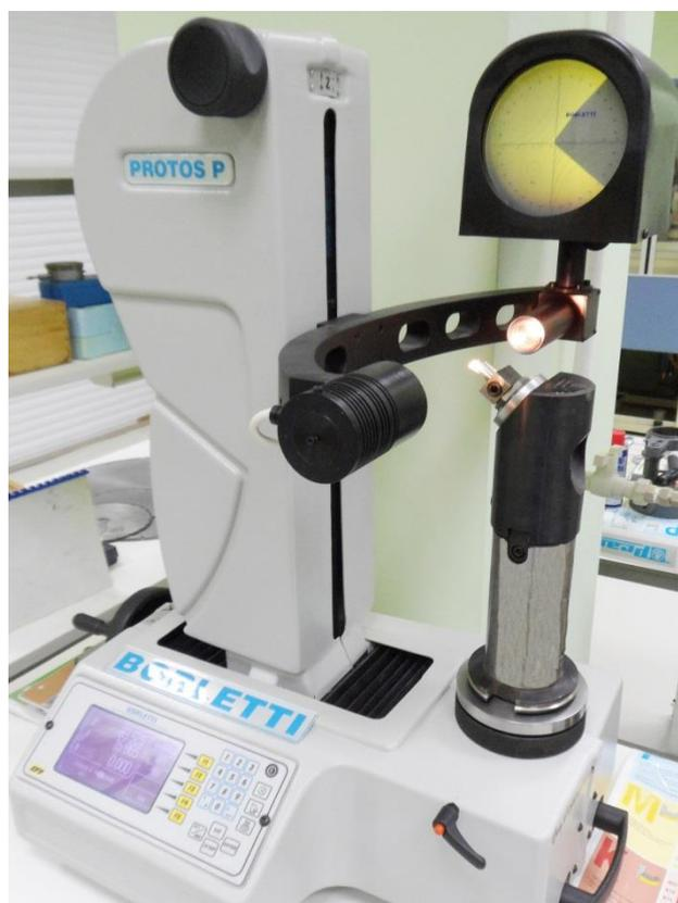
Рис. 9.4. Настройка расточной оправки на диаметр обработки на устройстве фирмы “Borletti”
