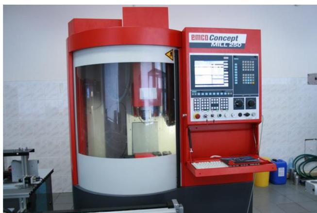
Рис. 4.4. Фрезерный станок (ГПМ)
