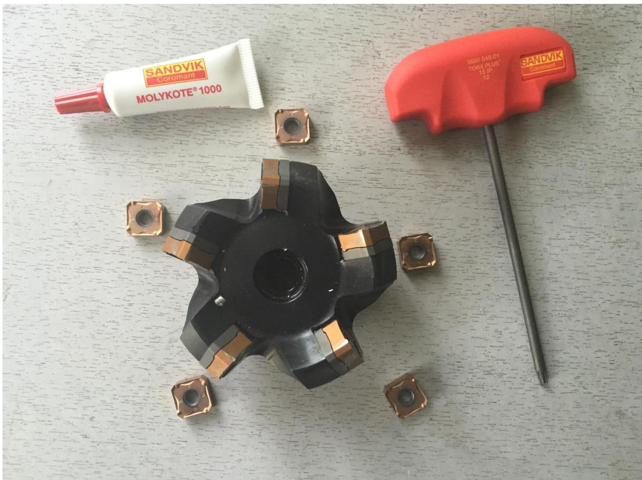
Рис. 8.4. Набор для замены сменных режущих пластин специальным, ключом и смазка для винта, закрепляющего пластину
