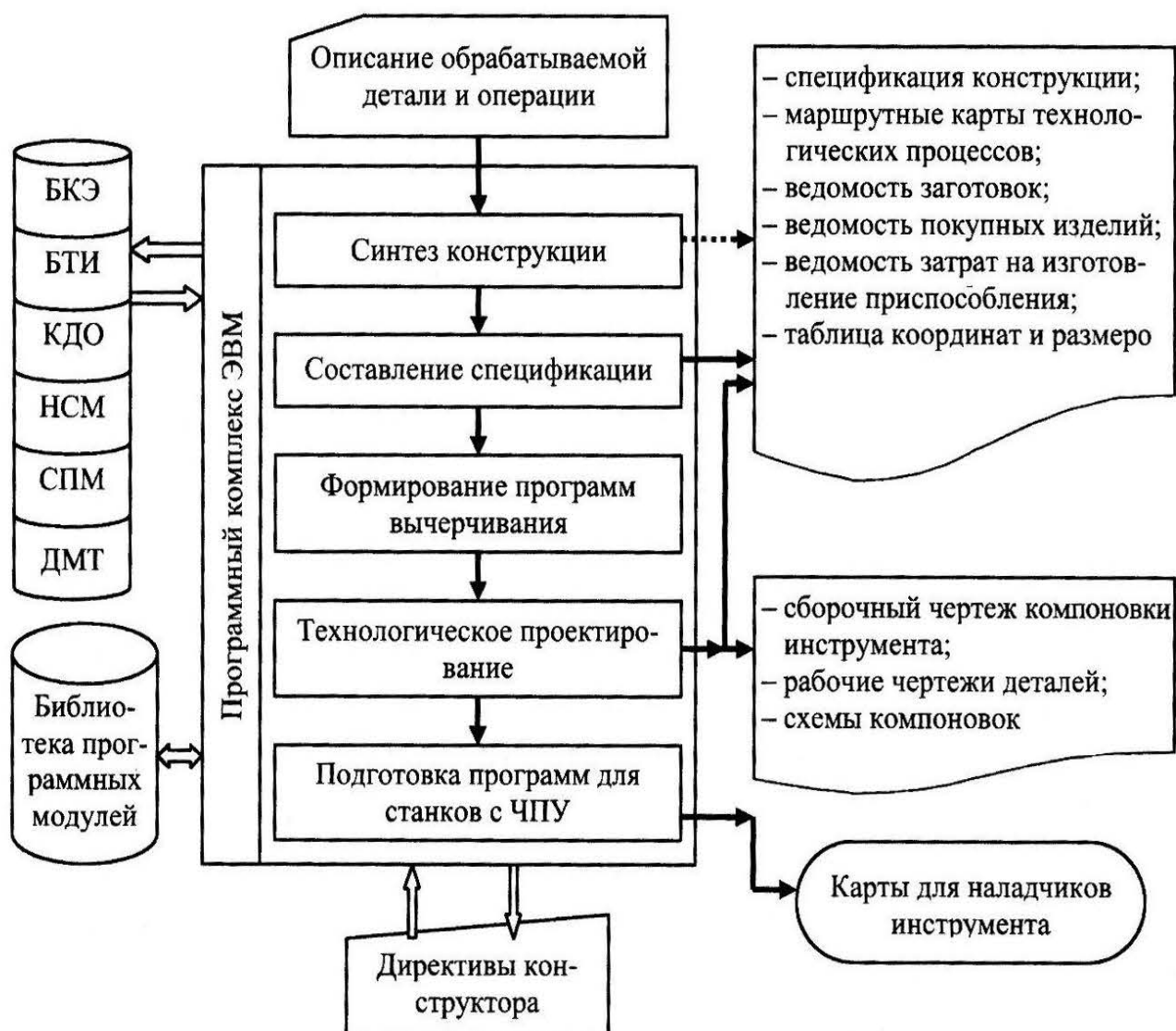
Рис. 7.1. Укрупненная схема автоматизированного проектирования приспособлений для закрепления инструмента
