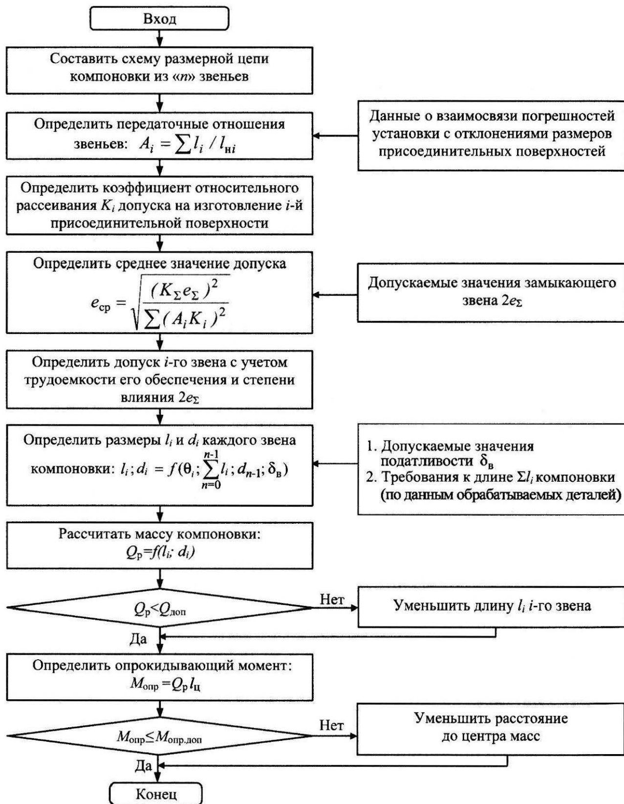
Рис. 6.4. Алгоритм расчета размеров и допускаемых отклонений на рабочие поверхности соединений сборки инструмента
