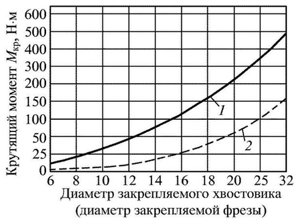
Рис. 3.17. Зависимости крутящего момента  $M_{зат}$ :
