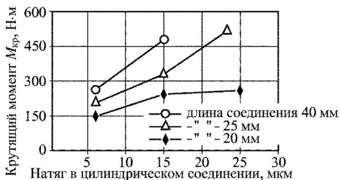
Рис. 3.25. Зависимость передаваемого крутящего момента от величины натяга в соединении «патрон — инструмент» диаметром 25 мм
